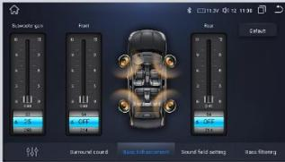
Désactivé par défaut (OFF). L'effet de basse peut être réglé pour différentes fréquences en glissant pour sélectionner la fréquence, par exemple 54Hz, et faire glisser la barre de progression en haut de la fréquence pour la régler, avec un intervalle de 0 à 12.
