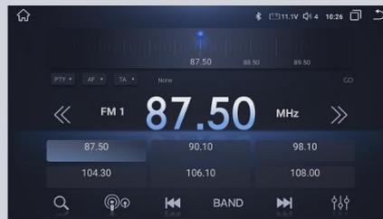
Cliquez sur le bouton de recherche 🔍, les stations valides trouvées seront affichées sur les boutons (P1 - P6). Si les boutons (P1 - P6) contiennent des stations, une pression courte sur l'un des boutons réglera la station correspondante sur le bouton. Faites glisser l'échelle de fréquence pour vous ajuster à votre station préférée et enregistrez cette station en appuyant longtemps sur l'un des boutons (P1 - P6).
