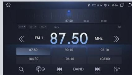
検索ボタンをクリックすると 🔍、検索した有効局が(P1-P6)ボタンに表示されます。(P1-P6)ボタンに局があり、あるボタンを短く押すと、ボタン上の局が設定されます。スライド周波数スケールを好きな局に合わせ、(P1-P6)ボタンを長押しして、局を保存します。
