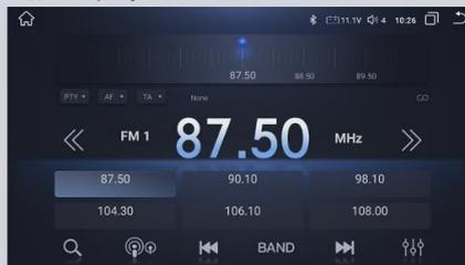
Нажмите кнопку поиска 🔍 и действительная радиостанция будет отображаться на кнопке (P1-P6). Если кнопка (P1-P6) имеет радиостанцию, короткое нажатие кнопки установит соответствующую радиостанцию на кнопке. Сдвиньте частотную шкалу, чтобы настроиться на любимую радиостанцию, вы можете долго нажимать кнопку (P1 - P6), чтобы сохранить радиостанцию.
